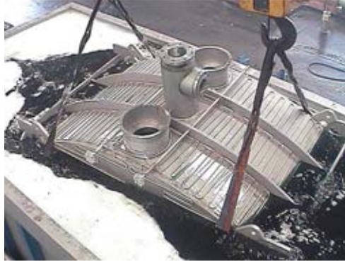
Tauchbeizen: Sofern die Abmessungen der Konstruktion dies zulassen, kann das gesamte Teil einer Tauchbehandlung unterzogen werden. Behandlungstemperatur und -dauer bestimmen das Beizergebnis.
