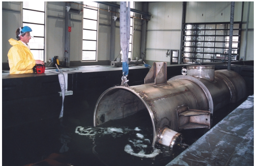
Bild 5: Sofern die Abmessungen der Konstruktion dies zulassen, kann das gesamte Bau- teil im Tauchbeizverfahren behandelt werden
